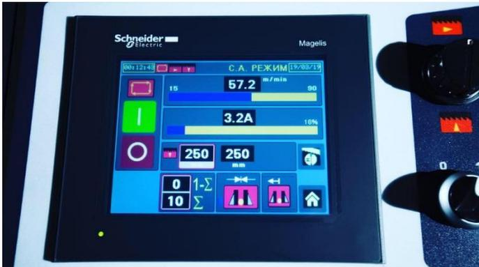
Основное меню полуавтоматического режима. В процессе резания на дисплее отражается число отрезанных заготовок, скорость пилы, скорость
