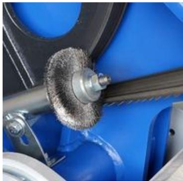
Щётка для снятия стружки с эл. Приводом, **KD**
