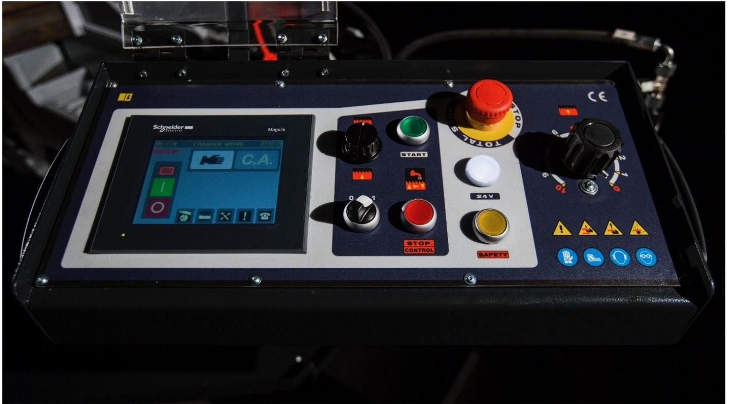
Эргономичная панель управления, большой сенсорный дисплей 10,2 дюйма производства Schneider electric. Позволяет просто и интуитивно управлять всеми функциями станка.
