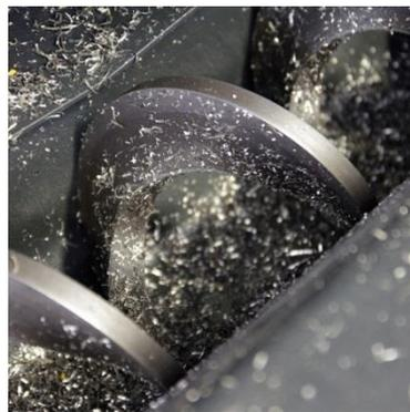
Конвейер для сбора стружки, **SD**
