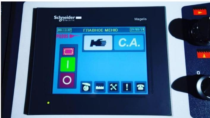
Главное меню позволяет выбрать два возможных варианта работы: полуавтоматически и ручной.
