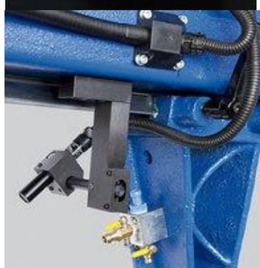
Лазерный указатель линии реза, **LS**
